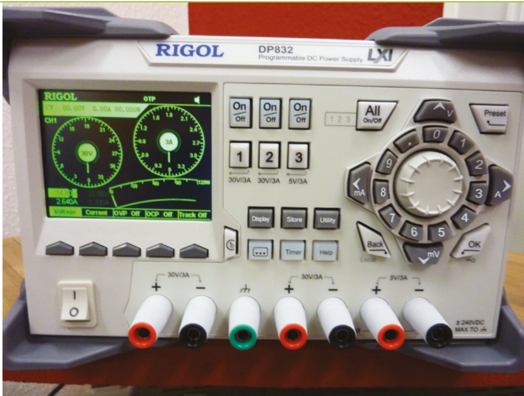
Façade du DP832. On y retrouve deux sorties 0-30V et 0/3A, plus une 0-5V/0-3A ainsi qu'un ensemble de contrôles plus ou moins ergonomiques. L'écran présente ici une déclinaison « fun » de l'interface accessible par un bouton dédié. Quelqu'un se sert-il réellement de ce mode d'affichage absolument anti-ergonomique ?
