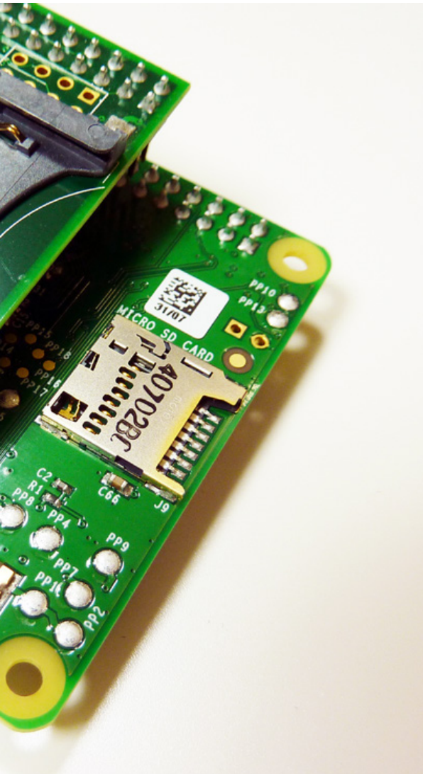
L'emplacement à friction pour la carte SD est remplacé par un emplacement microSD push-pull, plus compact, moins sensible aux vibrations.
