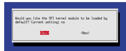
Activation du bus SPI dans raspi-config
