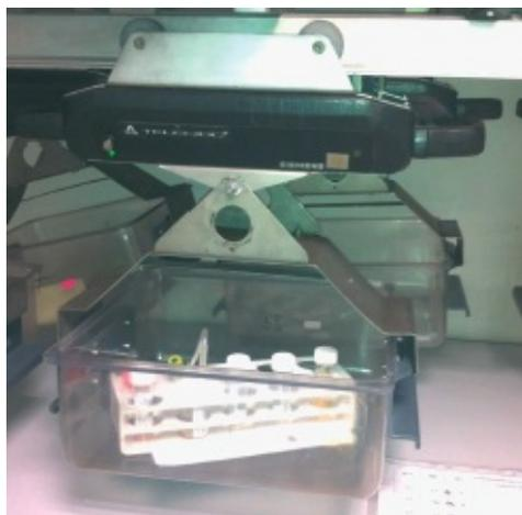
*Photo d'un transporteur interne de type balancelle*
