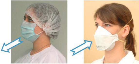
Figure 4.24. Exemples de masques : à gauche le masque de soin destiné à protéger l'environnement et les autres, à droite, l'appareil de protection respiratoire (APR) destiné à protéger le porteur.
