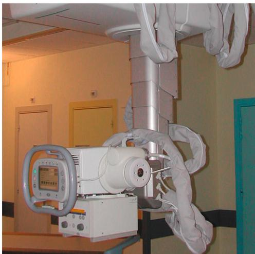
Figure 3.14. Tube radiologique GE avec la protection des câbles (General Electric Healthcare).
