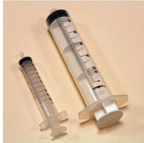
Figure 3.17. À gauche, une seringue de 10 mL à embout simple. À droite, une seringue de 60 mL à Luer Lock.
