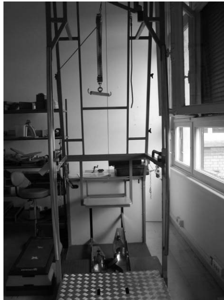
Fig. 1.64. Dispositif pour marche en suspension partielle
