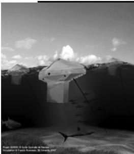
Une ferme houlomotrice sera constituée de plusieurs dizaines de modules SEAREV (Système Électrique Autonome de Récupération de l'Énergie des Vagues) ancrés par 30 à 50 m de fond, donc à 5 ou 10 km des côtes. L'électricité sera transportée à terre par un câble sous-marin.
