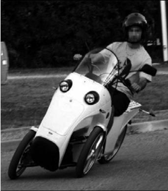
Le Tri'Ode est un véhicule électrique à trois roues. Il combine une architecture longitudinale issue des véhicules à deux roues et une architecture transversale de voiture au niveau du train avant. Ce type de disposition présente l'avantage d'être plus stable qu'un « deux roues » classique, d'avoir une meilleure tenue de route et une distance de freinage plus courte d'environ 20 %.
