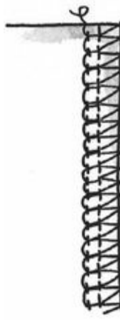
Figure 6-6 : Une couture de 0,6 cm faite avec une surjeteuse.
