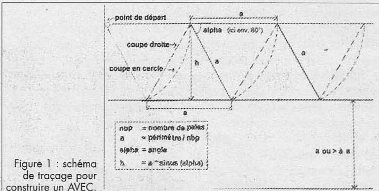
Figure 1 : schéma de traçage pour construire un AVEC.
